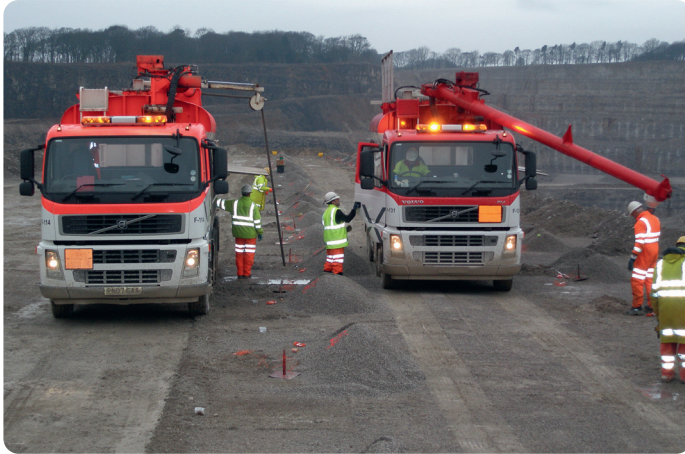
RIOXAM BK wird direkt vom Ladefahrzeug ins Bohrloch verblasen
