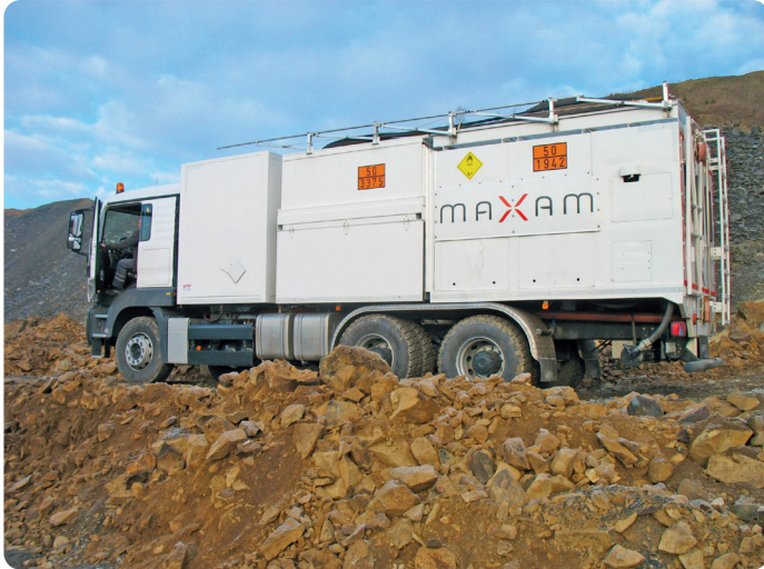
RIOMEX Pumpfahrzeug produziert RIOMEX 7000 / 7000 AL, der „Allround-Sprengstoff“ für kompakte bis zähe Gesteinsarten
